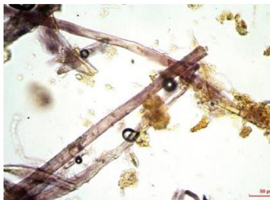
Obrázek 2 Vlákninové složení vzorku papíru z pokryvu EB_01, Herzbergova zkouška
