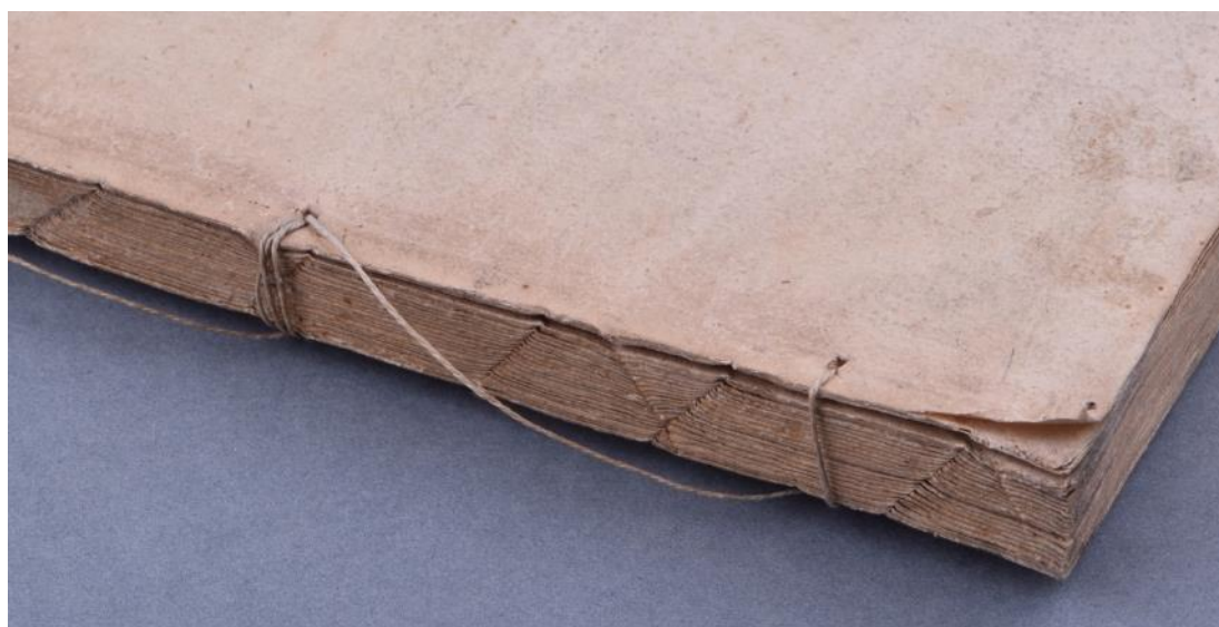
Obr. 140 Detail šitia hrubou niťou prevlečenou skrz knižný blok a okolo chrbta.
