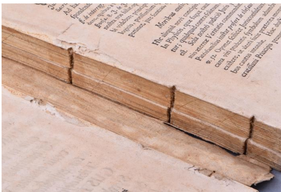
Obr. 150 Detail na zárezy a gledený chrbát knižného bloku s chýbajúcim organizmom šitia.
