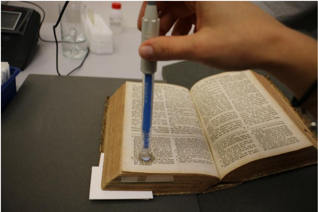
Obr. 391 Meranie pH papierovej podložky.
