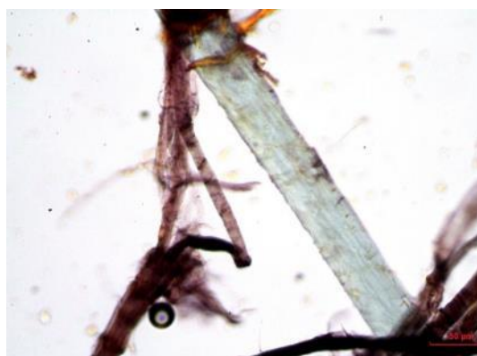
Obrázek 4 Vlákninové složení vzorku papíru z knižní desky EB_02, Herzbergova zkouška
