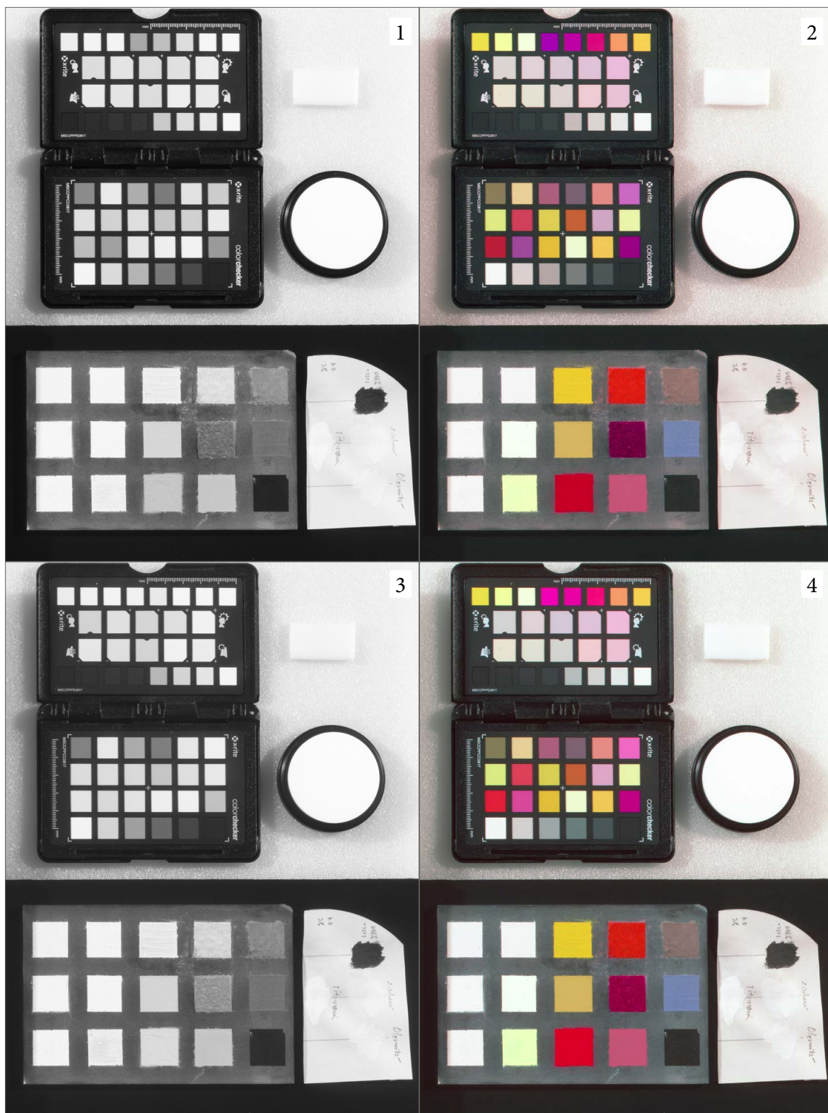
Obr. 46: Sada čtyř obrazů spektrální fotografie IRR s kalibračními nástroji, standard Spectralon s 99% odrazivostí, X-RITE ColorChecker Passport Photo 2 a 15 referenčními pigmenty, 1) IR fotografie s filtrem RG 830 (IRR830); 2) falešné barvy IR fotografie ze snímku s použitým filtrem RG830 (IRRFC830); 3) IR fotografie s filtrem X-Nite 1000 B (IRR1000); 4) falešné barvy IR fotografie ze snímku s použitým filtrem X-Nite 1000 B (IRRFC1000).
