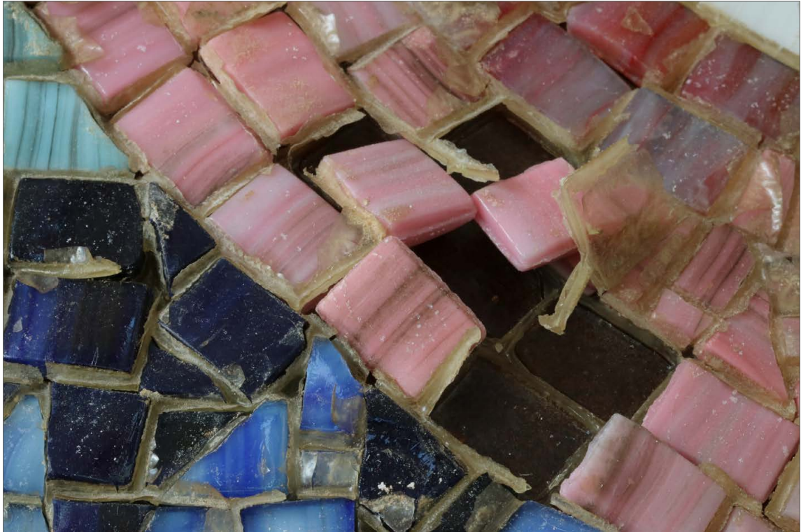
Obr. 50: Skleněná mozaika s motivem racka – detail degradované epoxidové pryskyřice s odlupujícími se mozaikovými kostkami.
