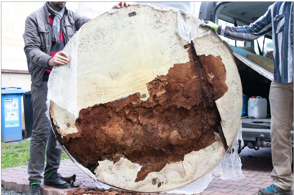
Obr. 52: Skleněná mozaika s motivem racka – pohled na zadní stranu dřevotřískového panelu po sejmutí ze stěny.
