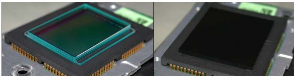
Obr. 09: CCD snímač ( Nikon D200 ) s vnitřními filtry (vlevo) a po odstranění filtrů (vpravo). [Infrared and ultraviolet photography, dostupné na: http://www.astrosurf.com/luxorion/photo-ir-uv.htm ]
