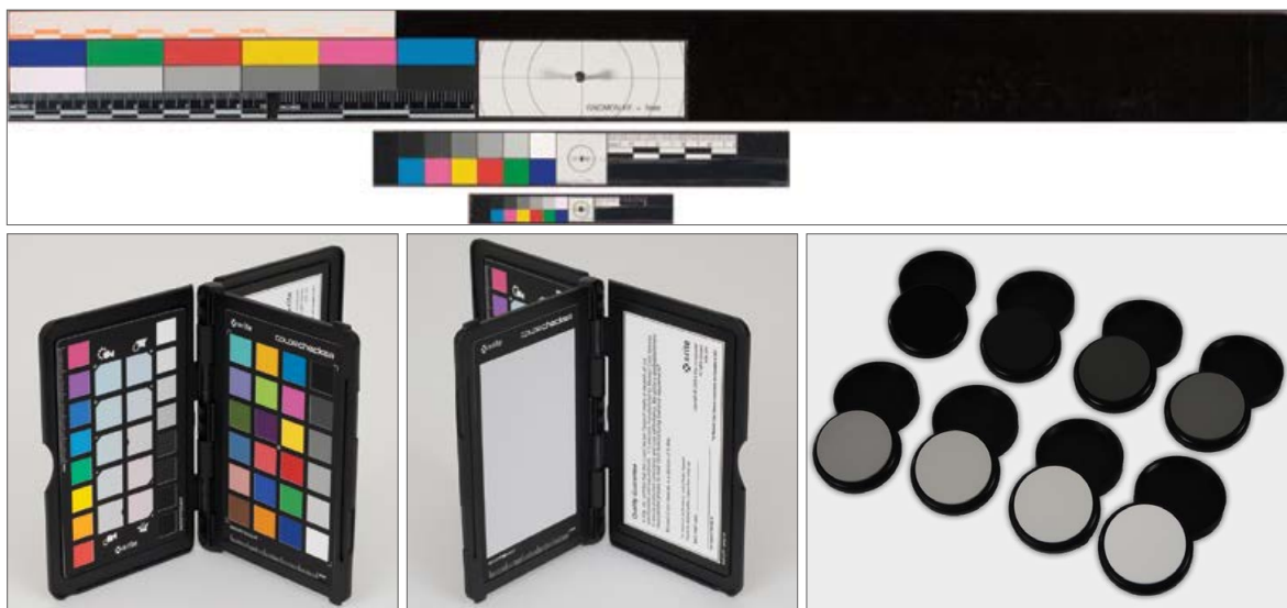
Obr. 19: Vybrané kalibrační tabulky a standardy, tabulka AIC PhD Target od AIC institutu (nahore), tabulka s referenčními cíli X-Rite ColorChecker Passport ® od firmy X-rite (vlevo) a difúzně odrazivé standardy Spectralon od firmy Labsphere černo-bílé škály (vpravo) [WARDA, 2011.; SPECTRALON ® , 2020.].
