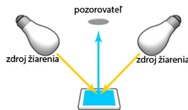
Obrázok 2 – Geometria merania 45^\circ/0^\circ
