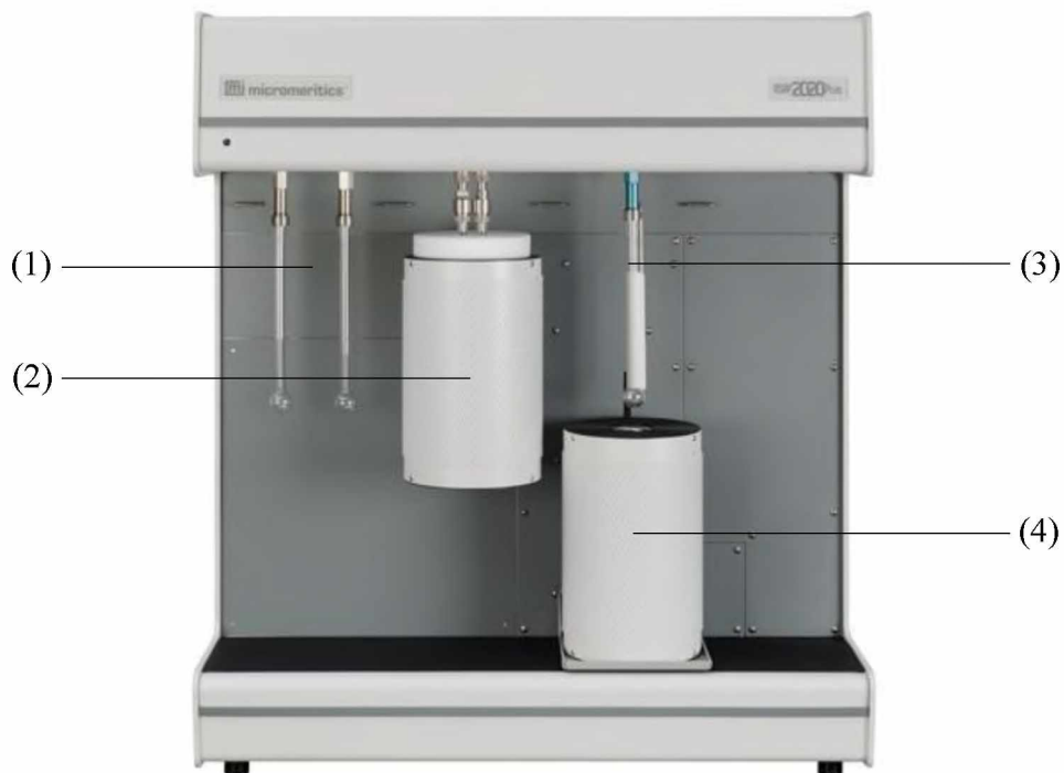
Obrázek 14: Příklad ASAP 2020 Plus Physisorption společnosti Micromeritics 53 (1 – odplynovací port, 2 – vymrazovací prsty v Dewarově nádobě s kapalným dusíkem, 3 – měřicí port, 4 – Dewarova nádoba s kapalným dusíkem pro udržování konstantní teploty během experimentu – pro teploty 0-80 °C se používá termostat na bázi Peltierových článků)
