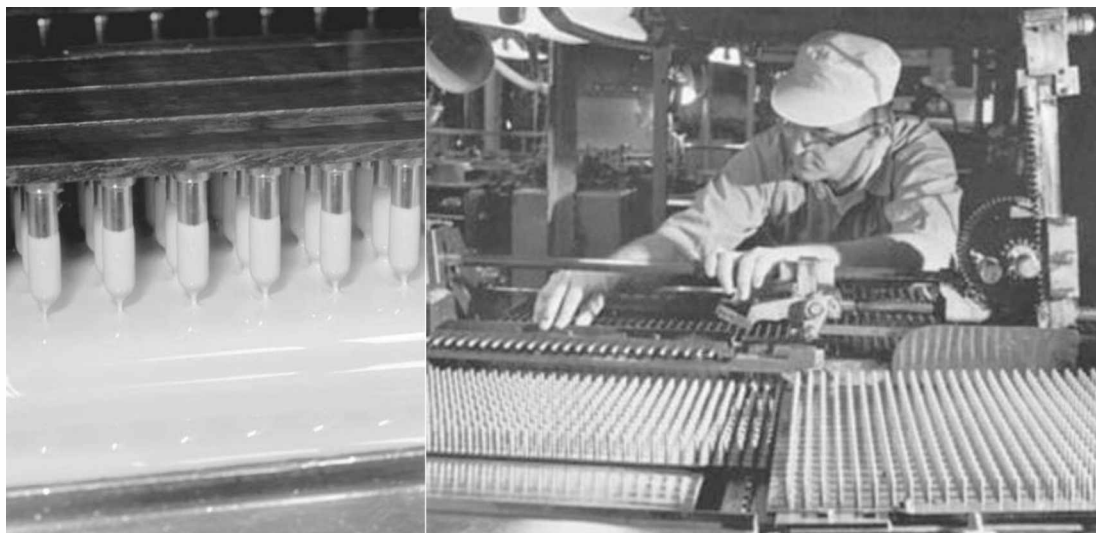
Obrázek 3: Výroba tvrdých tobolek: máčení válečků (vlevo), seřizování stroje (vpravo) [5]
