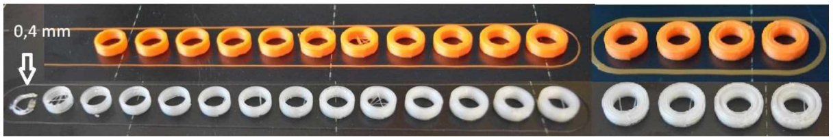
Obrázek 11: Testovací prstence pro porovnání teoretické a praktické tloušťky stěny
