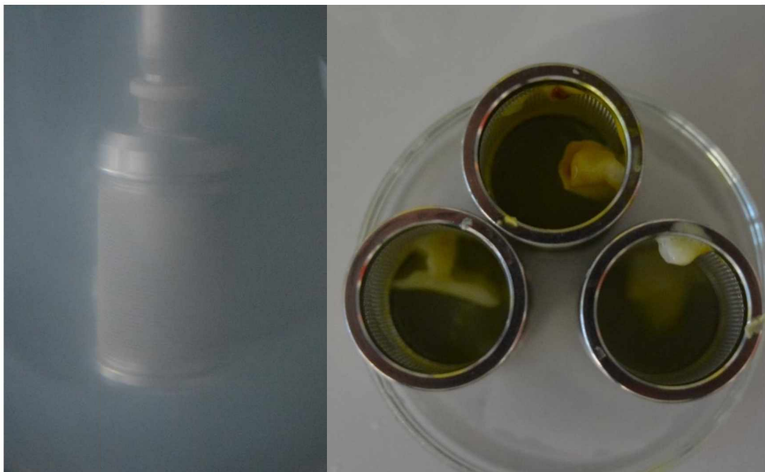
Obrázek 25: Zákal vznikající rozpouštěním PVA tobolky (vlevo), měkké zbytky tobolek v košíčcích (vpravo)
