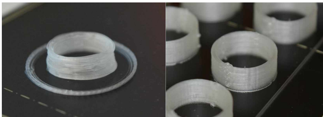
Obrázek 10: Porovnání výtisků při tisku jednoho prstence (vlevo) a deseti prstenců (vpravo)
