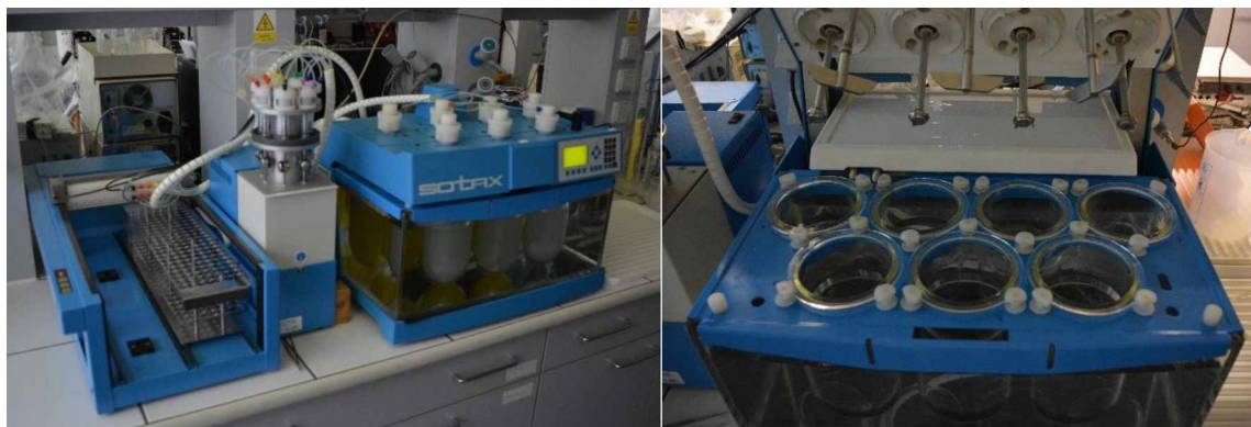
Obrázek 6: Přístroj pro disoluční testy SOTAX AT 7SMART s automatickým odběrem vzorků a kolektorem vzorků
