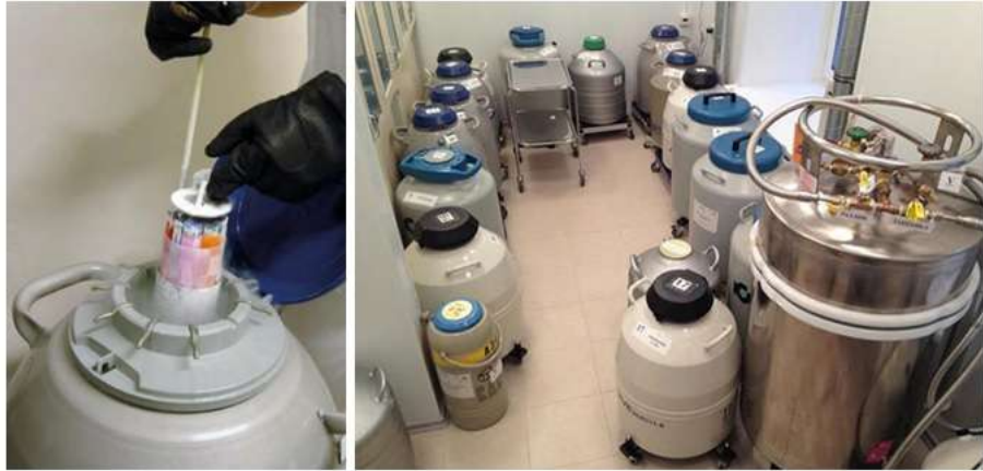
Obrázek 20 - Uložení pejet v kryokontejneru s kapalným dusíkem [30, 126]
