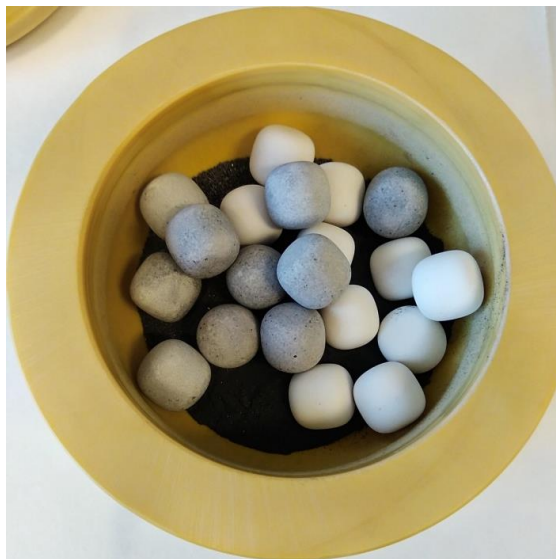
Obr. 21: Zirkonová mlecí nádoba naplněna korundovými mlecími tělesy a vzorkem \text{Sb}_6\text{Se}_{94} (a).
