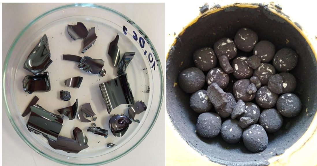
Obr. 20: Vlevo amorfnní Se připravený prudkým ochlazením taveniny v křemenné ampuli. Vpravo Mlecí nádoba s mlecími tělesy a částečně rozemletým amorfnním Se po 293 minutách mletí z první sady vzorků.
