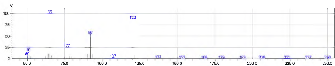
Příloha 4 – Hmotnostní spektrum ortho-Nitrotoluenu v režimu SCAN a módu NCI (reakční plyn methan)
