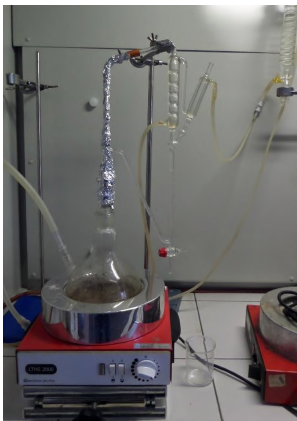
Obrázek 17: Aparatura pro hydrodestilaci
