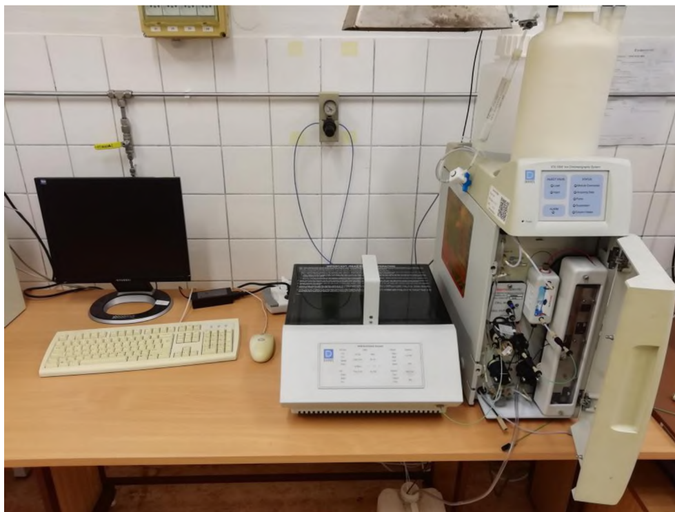
Obrázek 7 - Měřicí sestava - iontový chromatograf a autosampler
