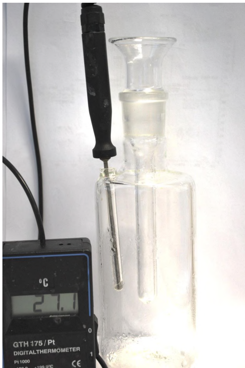
Obrázek 8. Aparatura pro měření rozpustnosti
