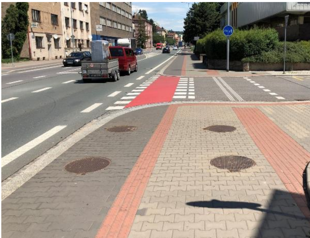
Obrázek 39 Příklad technického řešení místa pro přecházení
