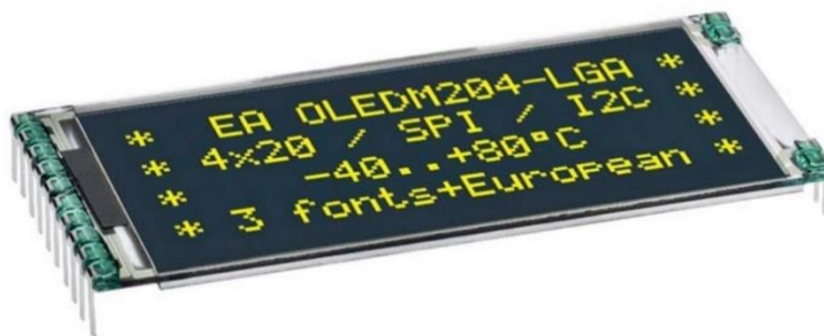
Obr. 23: Modul alfanumerického displeje EA OLEDM204 [16]
