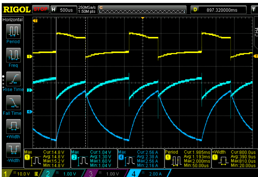
Obr. 70: Průběh proudu zátěži a napětí na bočniku H-můstku bez proudového omezení
