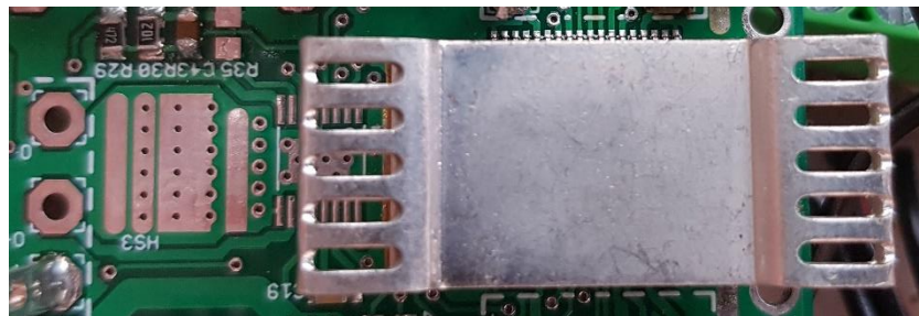
Obr. 41: Pohled shora na chladič dvojitého H-můstku a na chladičí plochu na DPS
