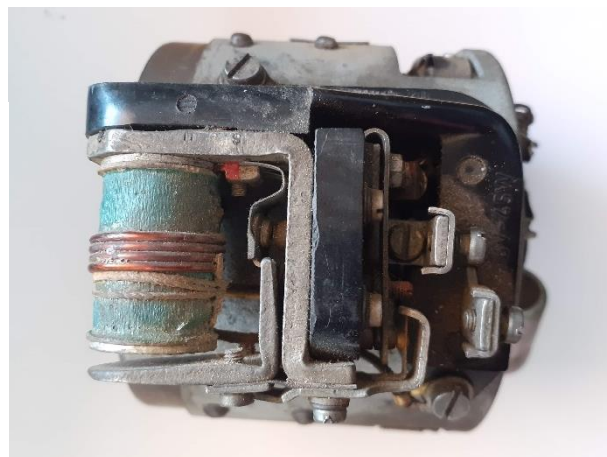
Obr. 6: Relé regulace buzení motocyklového dynama JAWA 45 W
