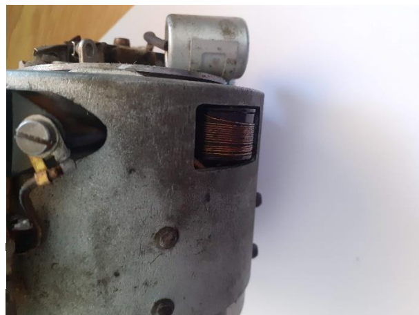
Obr. 8: pohled na pomocnou impedanci Z pro ochranu kontaktů relé buzení
