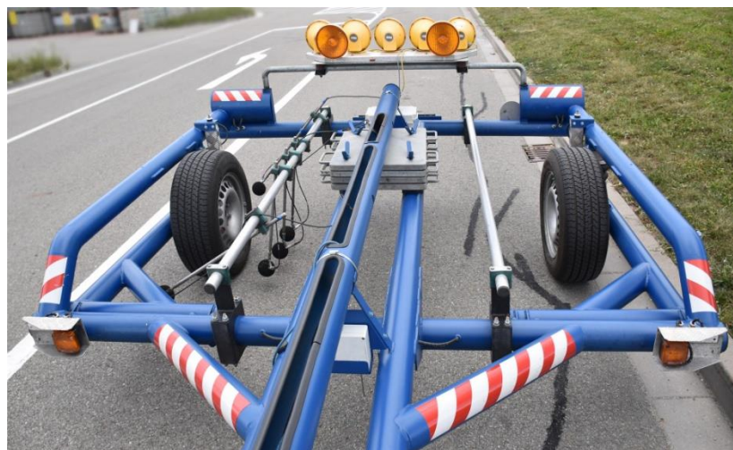
Obr. 11 Specializovaný přívěs pro měření metodou CPX [13]
