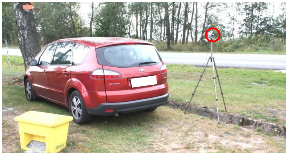
Obr. 29 Zaznamenávání dopravního proudu webkamerou Microsoft LifeCam Cinema HD
