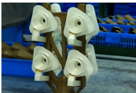
Obrázek 18 3D výtisky připravené na tvorbu formy pro lití metodou ztraceného vosku [40]
