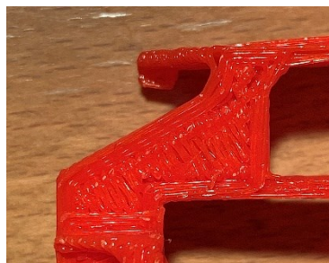
Obrázek 63 Povrch výtisku po odstranění podpěr
