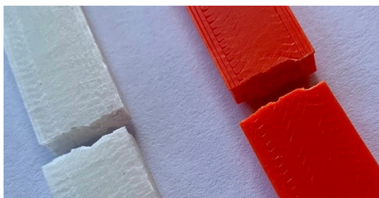
Obrázek 37 Lom zkušebních vzorků po tahové zkoušce
