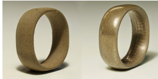
Obrázek 15 Bronzefill před a po vyleštění [31]
