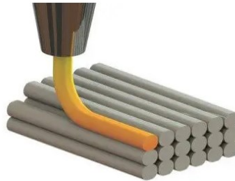
Obrázek 5 Nanášení vrstev materiálu FDM 3D tiskárnou [11]
