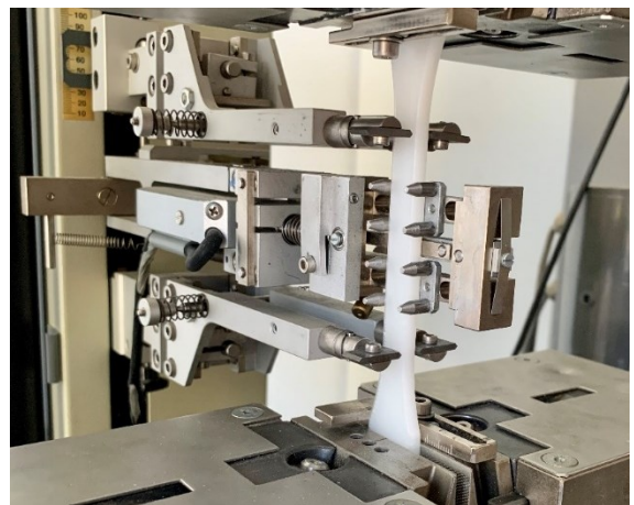
Obrázek 34 Měření mechanickým průtahoměrem (Zwick)
