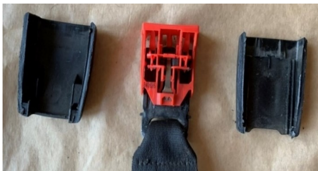
Obrázek 39 Rozříznutý zámek bezpečnostního pásu
