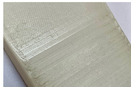
Obrázek 64 Porovnání tisku na podložku a na podpěry
