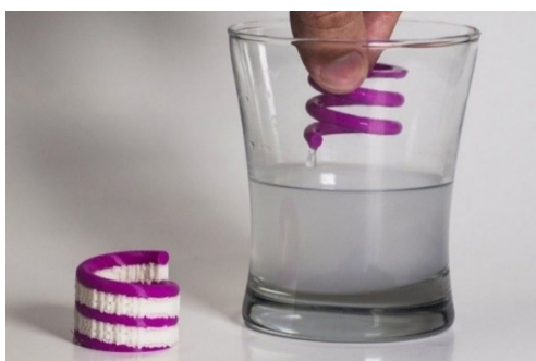
Obrázek 19 Rozpuštění podpůrného PVA ve vodě [44]
