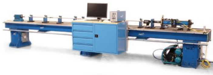
Obrázek 12 – Reálné provedení Hopkinsonova testu [15]
