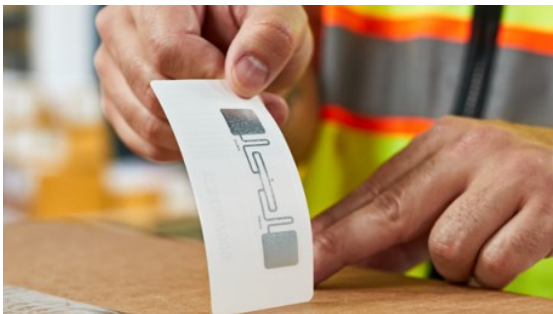
Obrázek 15 Etiketa s RFID (GEBRÜDER WEISS spol. s r.o., 2020)
