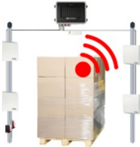
Obrázek 19 RFID brána umístěná v prostoru rampy (Eprin, 2020)
