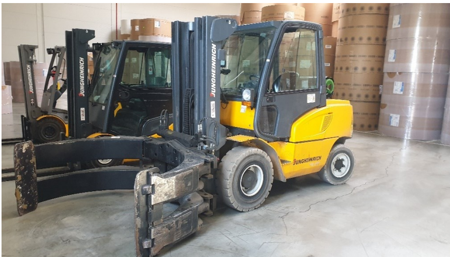
Obrázek 16 Vysokozdvihný vozík JUNGHEINRICH TFG 550 s kleštěmi (Autor, 2020)
