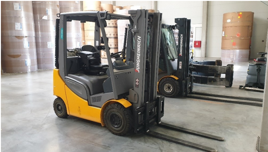
Obrázek 17 Vysokozdvihový vozík JUNGHEINRICH TFG 316s s vidlemi (Autor, 2020)
