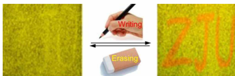
Obrázok 7: Proces zápisu a vymazania realizované s využitím BTPE-FN Prevzaté z literatúry [5]
