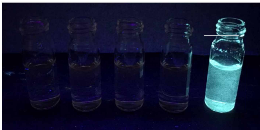
Obrázok P28: Luminiscencia 0,1 mM roztoku zlúčeniny 4h v zmesi acetonitril-voda (zľava 0, 30, 50, 70 a 90 % H 2 O)
