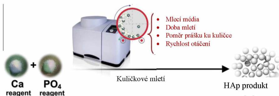
Obrázek 9 Výroba hydroxyapatitu mechanochemickým postupem (upraveno - přeloženo)
