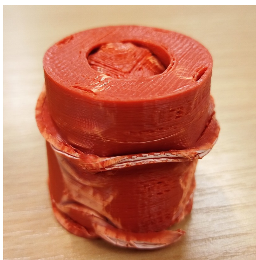
Obr. 90: Deformace zkušební tělesa Batwing ST válec
