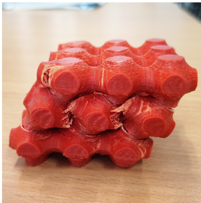
Obr. 84: Deformace ve vzpěru smykem výřezu z mříže Schwarz P ST
