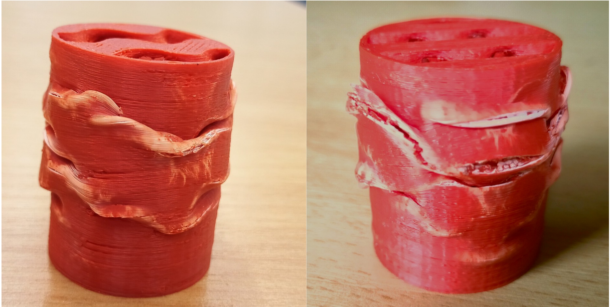
Obr. 87: Deformace zkušebních těles Gyroid ST válec (vlevo) a Diamond ST válec (vpravo)
