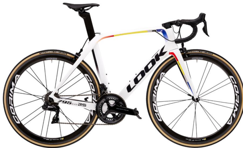
Obrázek 32: Silniční kolo s monokokovou konstrukcí rámu [30]
