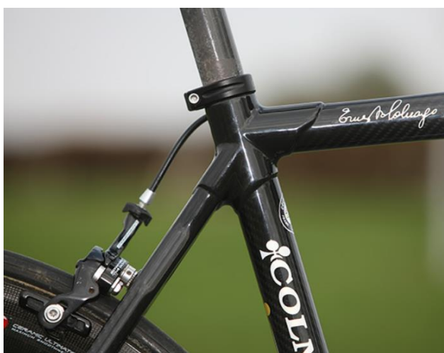
Obrázek 34: Konstrukce s použitím rámových spojek [33]
