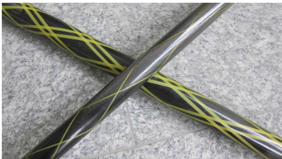
Obrázek 39: Pačiny vesel vyztužené uhlíkovými vlákny s aramidovými pásky [44]
