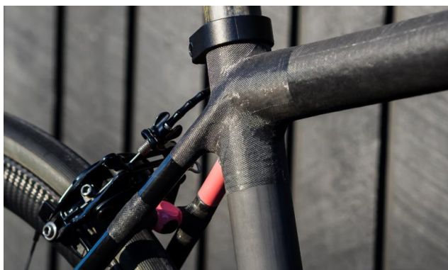
Obrázek 33: Konstrukce lepených trubek [31]
