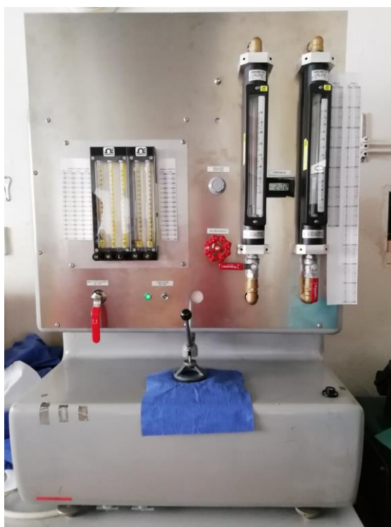
Obrázek 6 - Přístroj pro měření prodyšnosti vzduchu dle ČSN EN ISO 9237 z laboratoří TZÚ V Brně (Kobzová, 2020)
