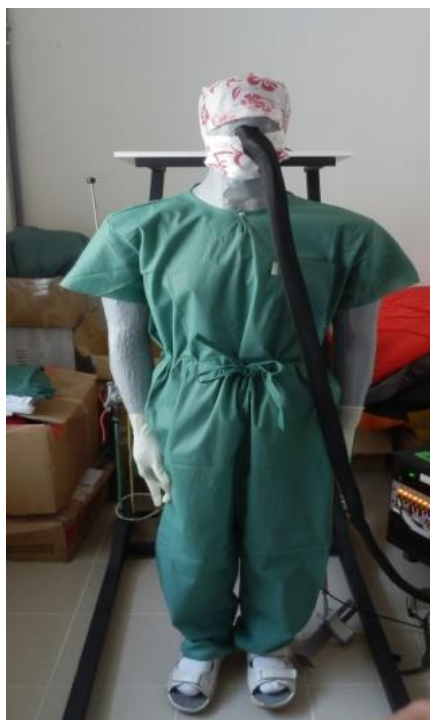
a) Figurína pro měření tepelné izolace s jednorázovým oděvem do čistých prostor v laboratořích v TZÚ.
