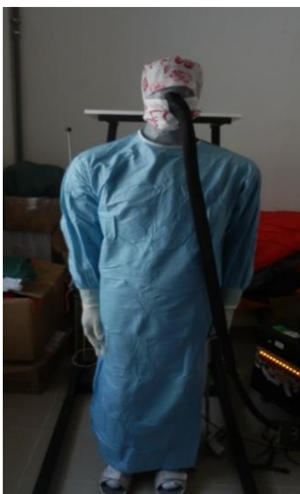
b) Figurína pro měření tepelné izolace s jednorázovým operačním pláštěm v laboratořích TZÚ.
