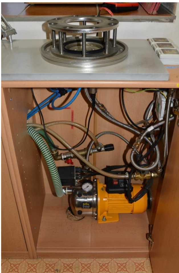
Obrázek 8 - Přístroj na měření bariérových vlastností podle ČSN EN ISO 811 (Kobzová, 2020).
