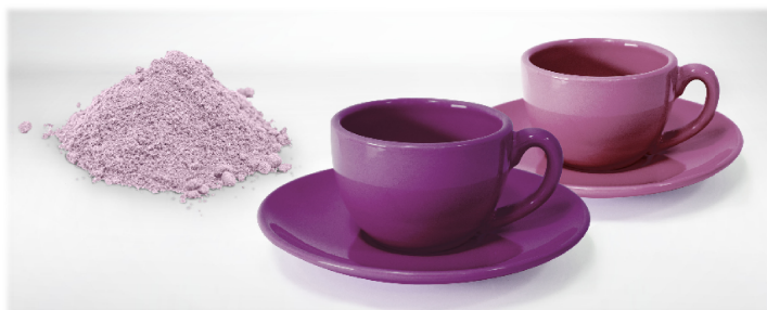
Obr. 2: Aplikace kasiteritové violeti produkované firmou Glazura s.r.o. do transparentní keramické glazury (vpředu) a do bílé krycí glazury (vzadu) [80]
