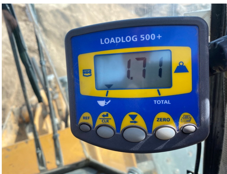
Obrázek 18 Vážicí systém v nakladači
