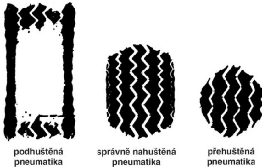
Obr. č. 6: Vliv huštění pneumatiky na tvar dotykové plochy [4]
