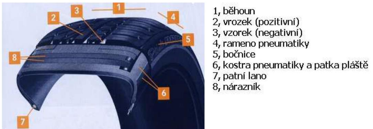
Obr. č. 5: Konstrukce pneumatiky [6]
