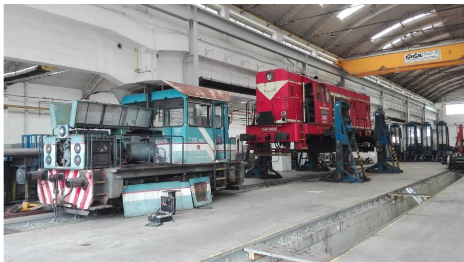
Obrázek 8 - Lokomotivy řady 797.4 a 740 při opravě v areálu společnosti Metrans Dyko
