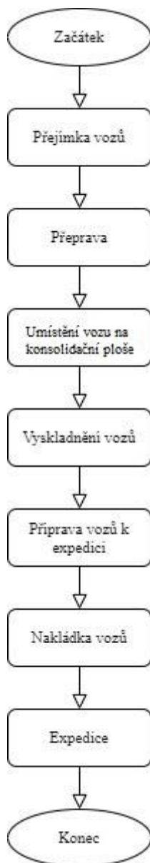
Obrázek 13 Schéma toku jednotlivých činností (ŠKODA AUTO, 2020e)
