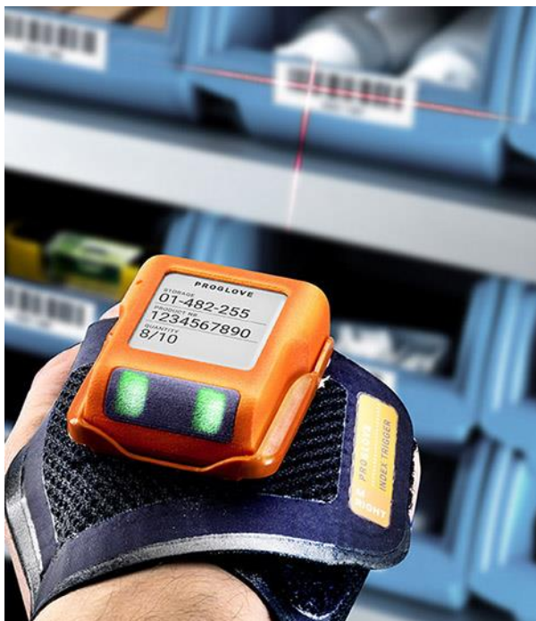
Obrázek 25 ProGlove MARK DISPLAY – chytrá rukavice se čtecím zařízením čárových kódů (ProGlove, 2020)
