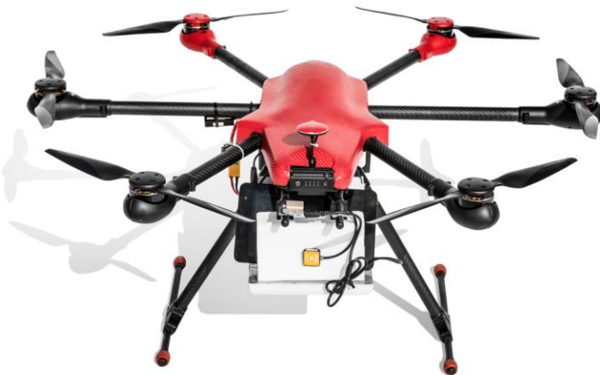
Obrázek 30 Bepilotní prostředek s namontovanou RFID čtečkou (Exponent Technology Services, 2020)
