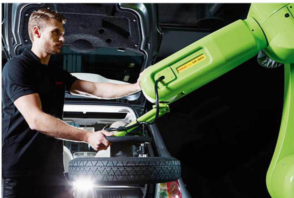
Obrázek 2.2 – Kooperující robot CR-35iA od společnosti Fanuc (Teaching a robot using hand guidance, 2019)
