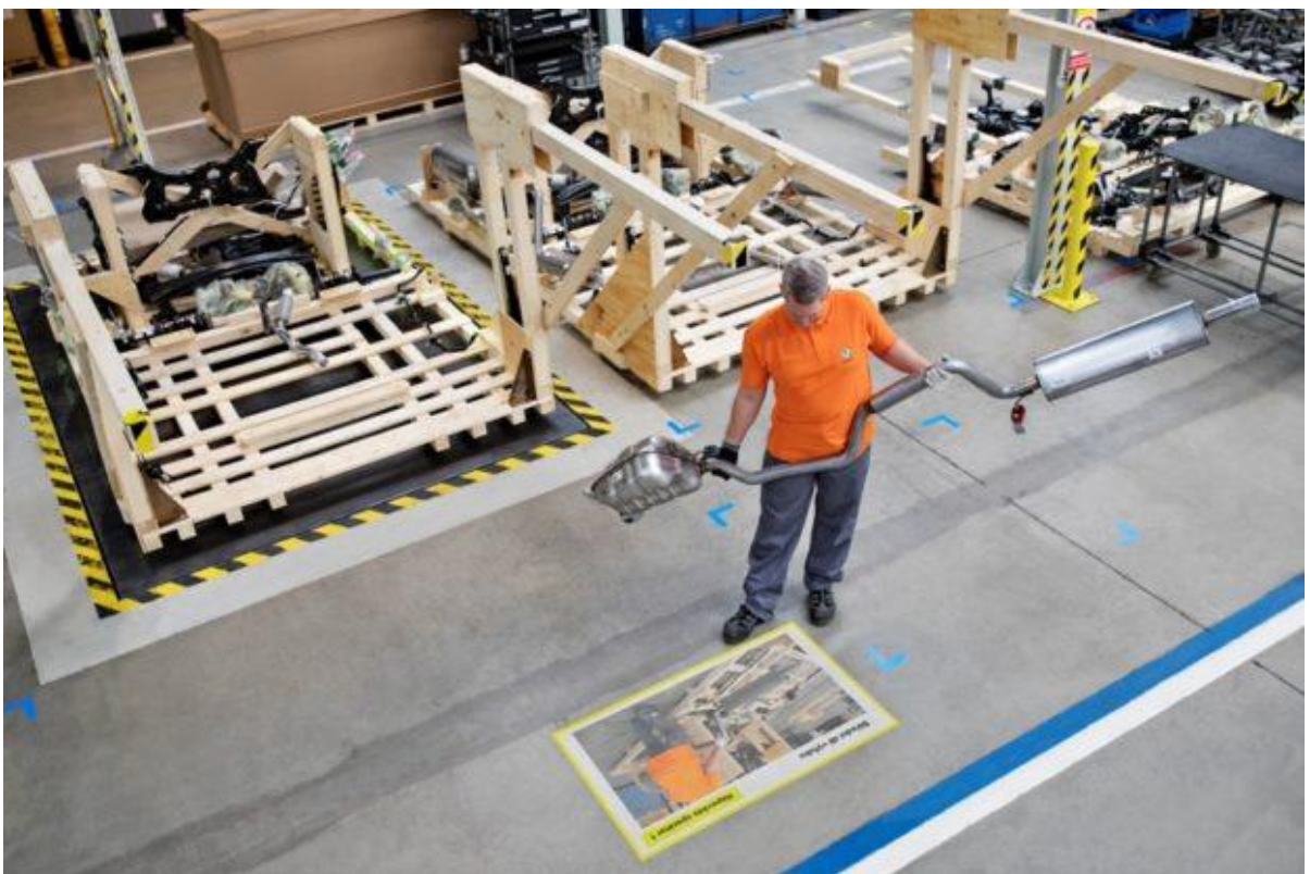
Obrázek 17 Nakládání dílů na paletu pomocí rozšířené reality
