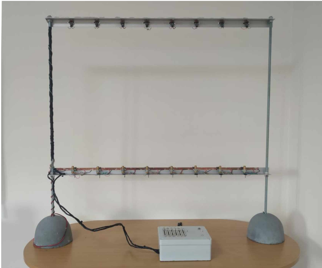
Obrázek 34 – laserová harfa a plastový box s řídicí elektronikou
