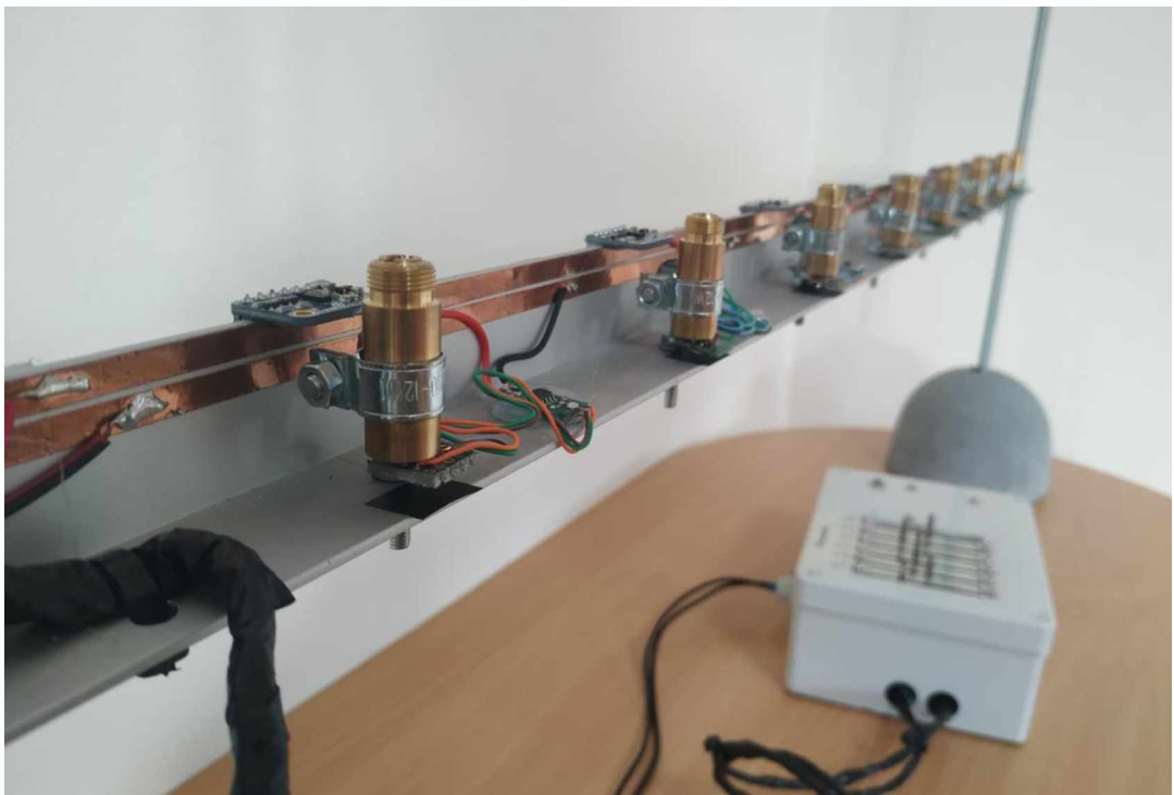
Obrázek 35 – osazení laserových modulů s driverem
