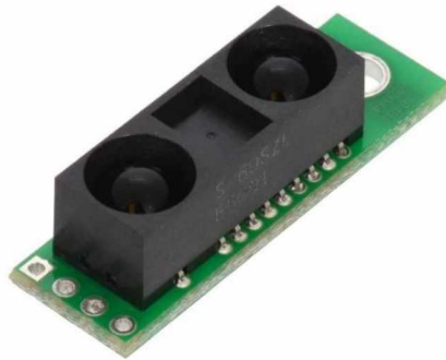
Obrázek 23 – senzor vzdálenosti Sharp GP2Y0A60SZLF [19]
