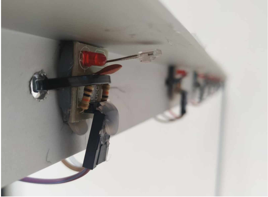
Obrázek 38 – osazení senzorů laserového paprsku
