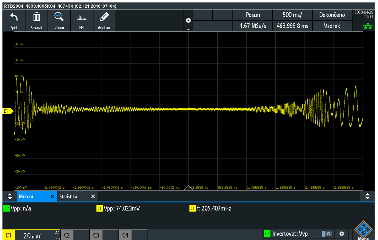
Obrázek 12: Měření odrazu od lidské ruky
