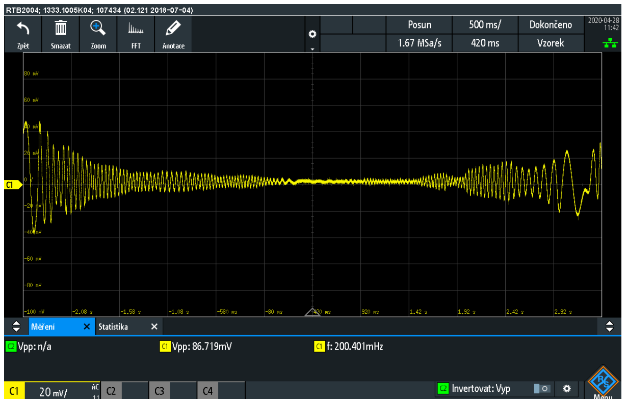
Obrázek 13: Měření odrazu od lidské ruky v blízkosti senzoru
