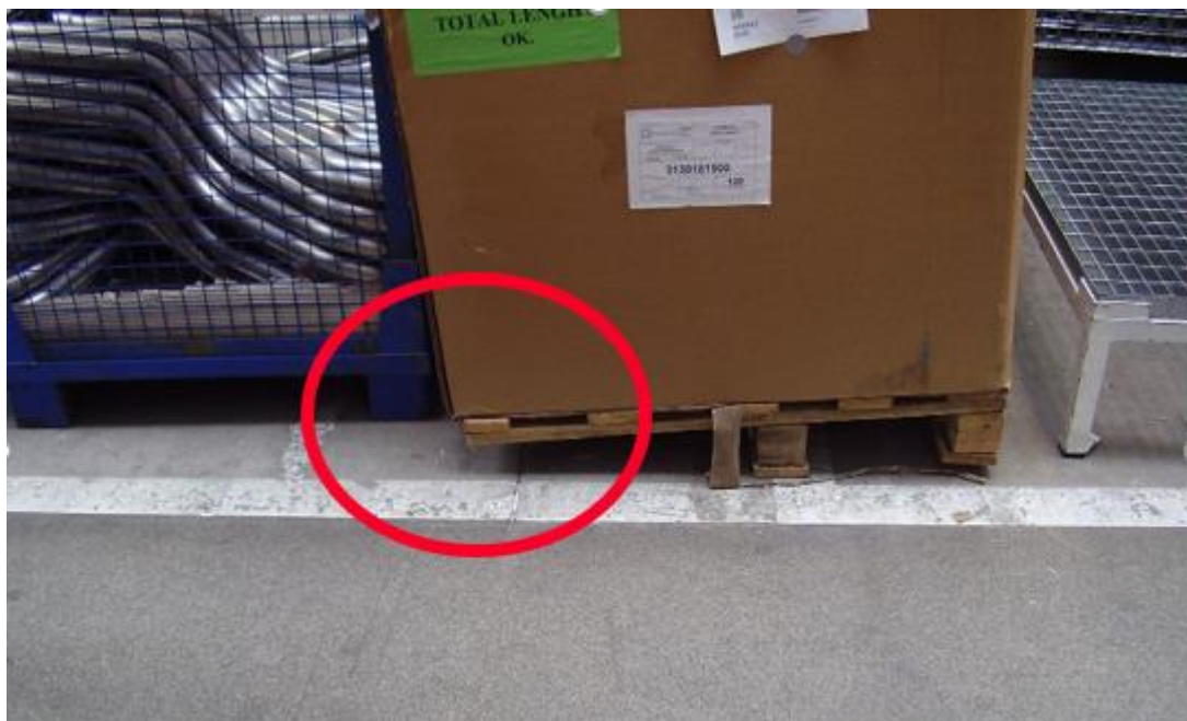
Obrázek 26: Poškozená manipulační jednotka
