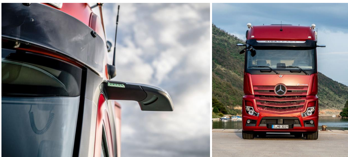
Obrázek 5 – Zpětná zrcátka MirrorCam Mercedes Benz
