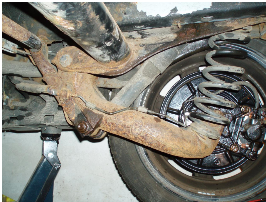
Obrázek 16: Rozsáhlá koroze podvozkových částí vozidla
