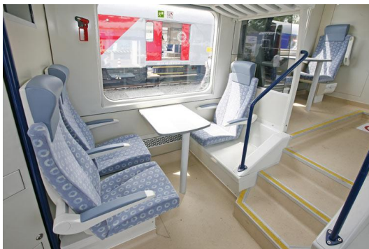
Obr. 8: Uložení sedadel v jednotce 440 [10]
