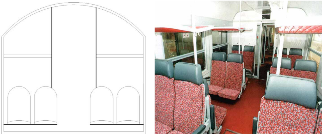
Obr. 6: Znázornění konzole uložené v bočnici a stropě vozu s konkrétním příkladem [8]
