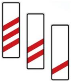
Obrázek 5 Kód: A 31a, A31b, A 31c Návěstní deska (240m, 160m, 80m) (MD, 2015)
