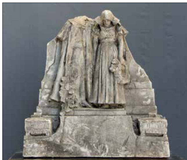
Obr. 1. Sádrový odlitek od sochaře Stanislava Suchardy vystavený nevhodným podmínkám, u kterého se výrazně projevilo strukturální poškození sádrového materiálu. Foto Radka Zůfalá Typical degradation of plaster cast by Stanislav Sucharda as a result of exposure to unsuitable environmental conditions. Photo Radka Zůfalá
