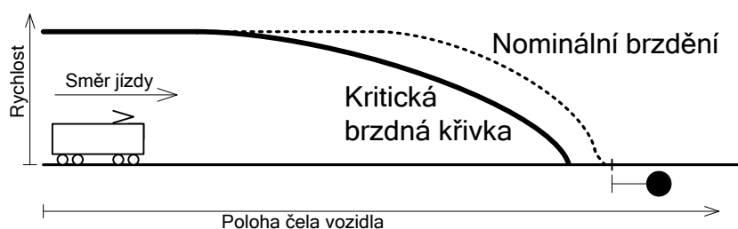
Obrázek 1: Ilustrace dohledu odrychlení při uvažování kritických podmínek k brzdění vs. brzdění za nominálních podmínek
