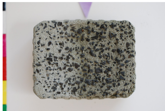
Zkouška tmelu z probarveného Betofixu RM plněného čedičovou drtí se dvěma způsoby zpracování povrchu.
