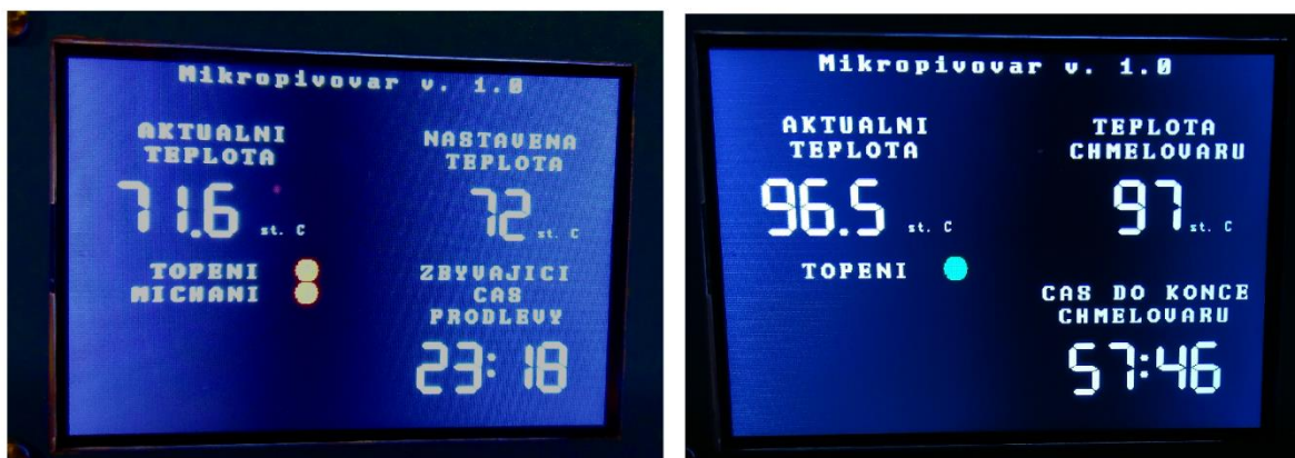
Obrázek 31: Výpis informací na displej v průběhu procesů rmutování a chmelovaru
