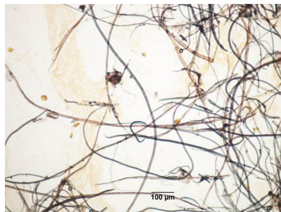
Obr. 12 Vzorek 5, vybarveno Graffovým „C“ roztokem, směs dlouhých lýkových vláken a rýžové buničiny
