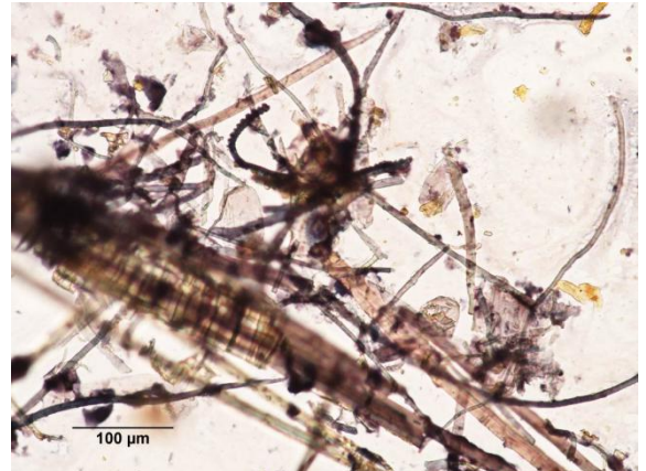
Obr. 8 Vzorek 3, vybarveno Graffovým“C“ roztokem, pokožkové buňky pravděpodobně rýžové a hnědě zbarvené lýkové vlákno
