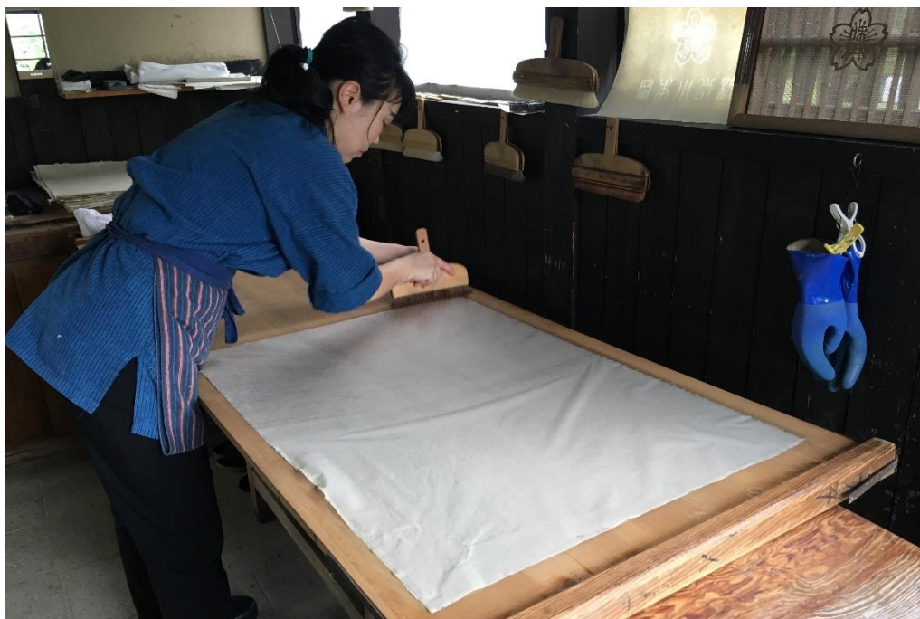
Obr. 5 Vypnutí archu papíru na dřevěnou desku
