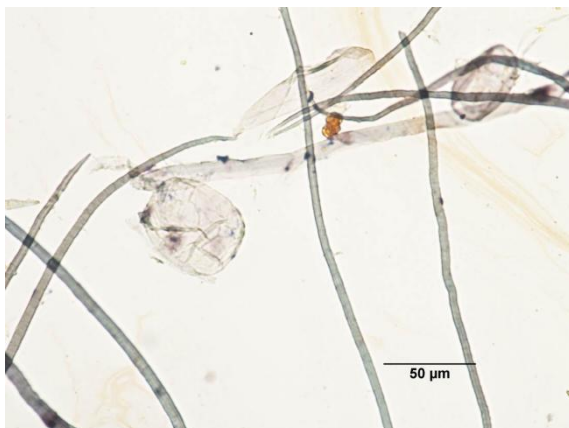
Obr. 9 Vzorek 4, vybarveno Graffovým“C“ roztokem, vlákna a parenchymatické buňky pravděpodobně rýžové slámy
