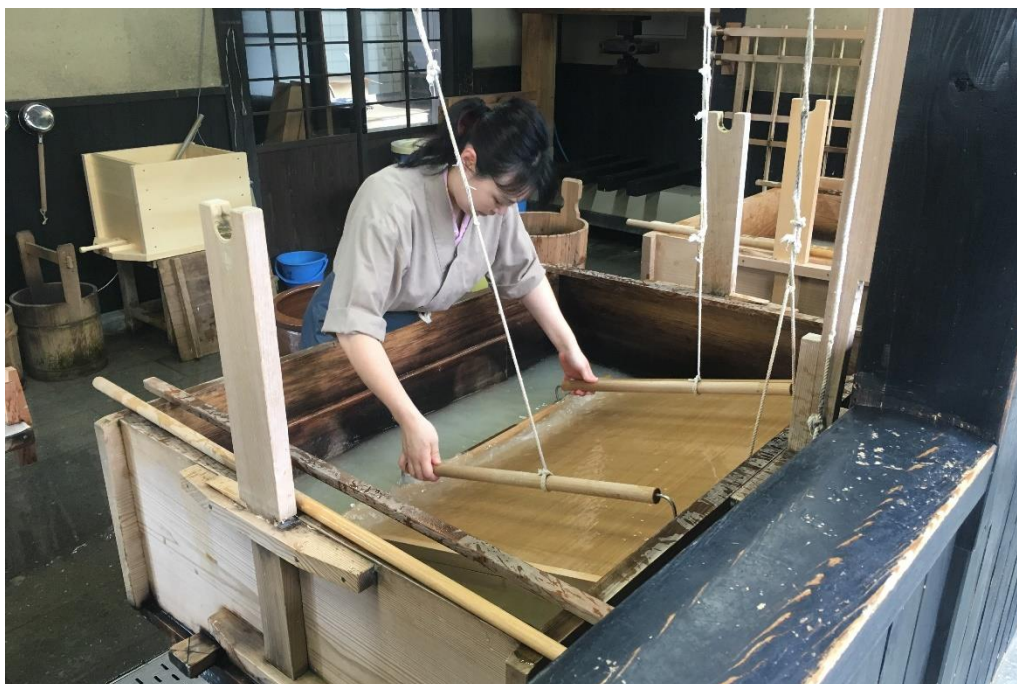
Obr. 3 Čerpání archu papíru technikou nagašizuki , kdy dochází k postupnému vrstvení vláken na sebe, což umožňuje vytváření tenkých a pevných papíru.
