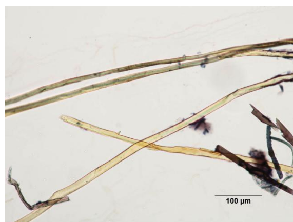
Obr. 4 Vzorek 2, vybarveno Graffovým „C“ roztokem, žlutá vlákna hedvábí
