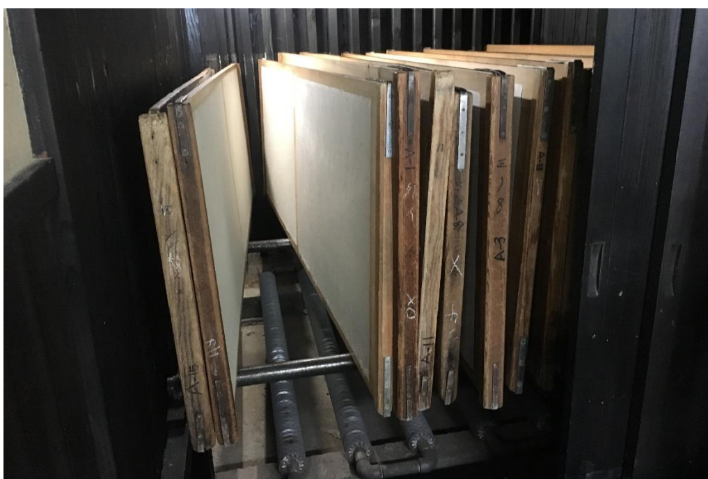
Obr. 6 Rovnění a sušení papíru ve speciální místnosti
