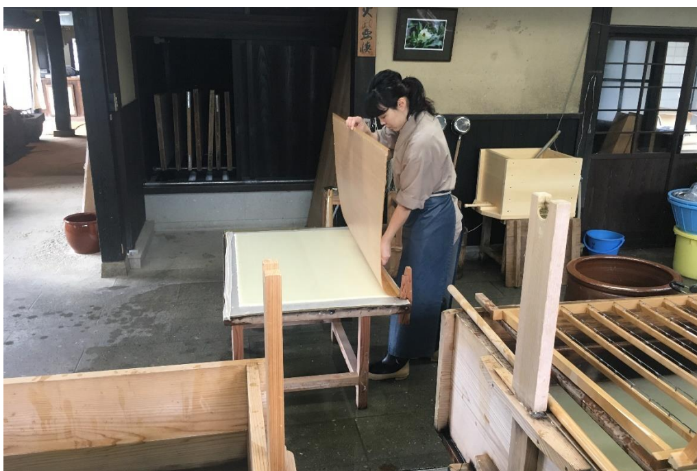
Obr. 4 Přenášení archu papíru z bambusového síta na štos mokrých archů.
