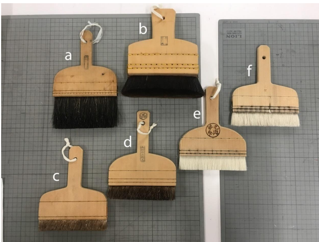
Obr. 8 Japonské štětce: a) nadebake, - rozhlazovací štětec, b) učibake, c) d) mizubake – štětec na vodní procesy, e) noribake (cukemawaši-bake) – štětec na lepení, f) noribake – štětec na lepení.
