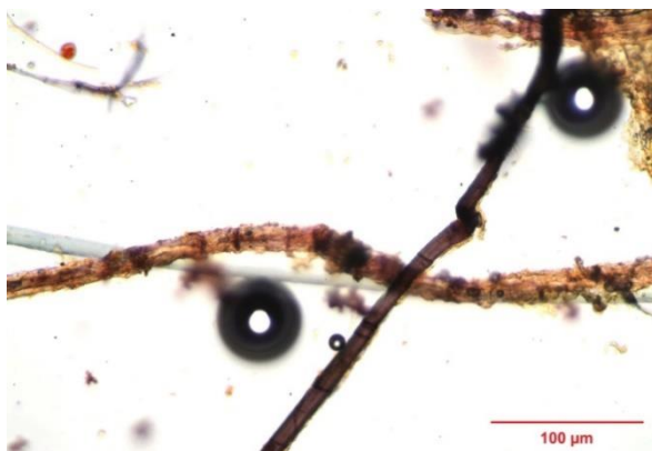
Obrázek 9 Vlákninové složení vzorku textilního plátna LK_01, Herzbergova zkouška.
