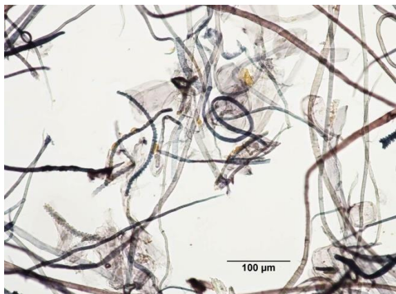
Obr. 1 Vzorek 1 s morfologickými znaky rýžové buničiny, vybarveno Graffovým „C“ roztokem
