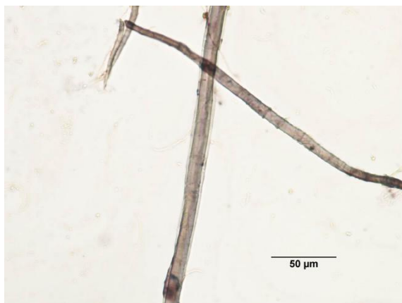
Obr. 11 Vzorek 4, vybarveno Graffovým „C“ roztokem, dlouhá lýková vlákna, pravděpodobně morušová
