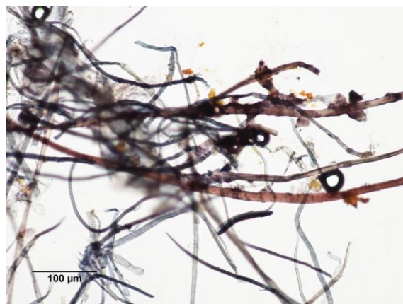
Obr. 2 Vzorek 1, vybarveno Graffovým "C" roztokem, rýžová vlákna modře zbarvená a lýková vlákna hnědočervená
