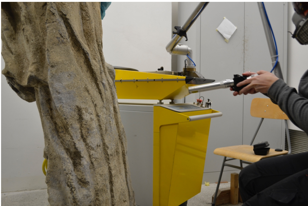
Obrázek 56 Čištění sádrovcové krusty Laserem
