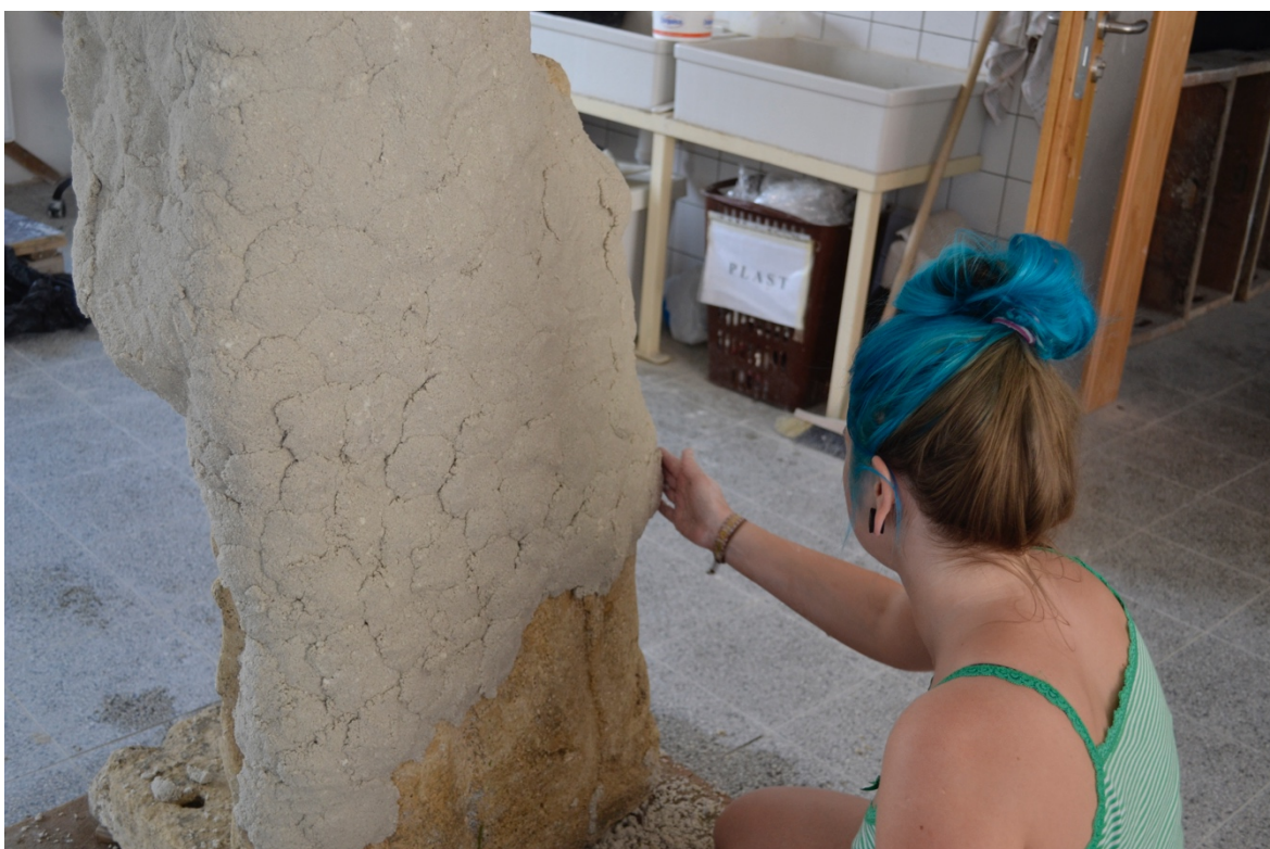
Obrázek 55 Nanášení odsolovacího zábalu
