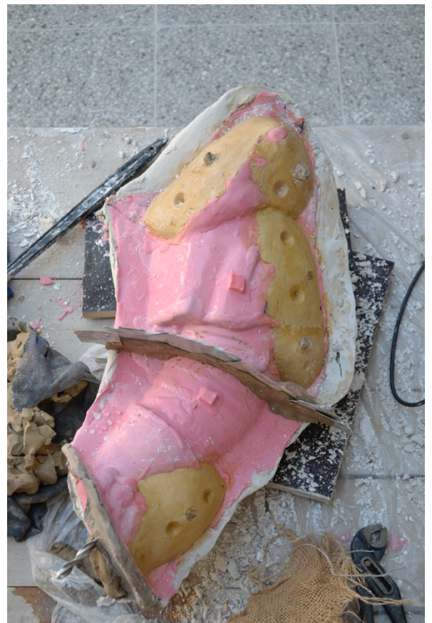
Obrázek 59 Průběh formování nových doplňků
