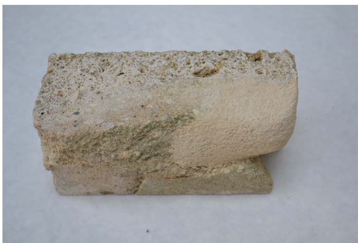
Obrázek 12 Tmelicí směs, použita na vzorku stejného typu vápence
