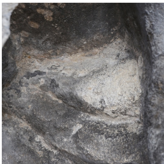
Obr. 36 Výsledný efekt po půl hodině působení uhličitanu amonného v zábalu (horní část) a po jedné hodině působení uhličitanu amonného v zábalu (spodní část)
