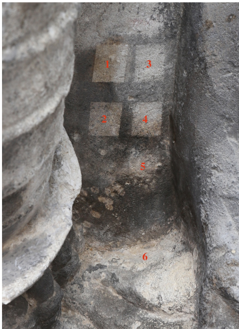
Obr. 38 Výsledek odstraňování sádrovcové krusty na vápenci vybranými metodami, bližší popis provedených zkoušek v Tab. 9
