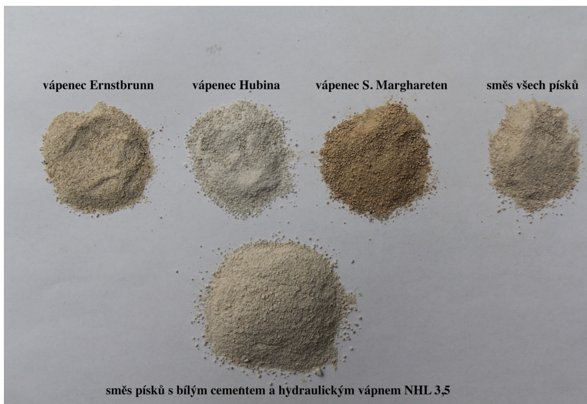
Obr. 15 Složení a postupná výstavba vybraného tmelu pro výdusek (Vz. č. 1 v Tab. č. 7), viditelné v jednotlivých komponentech
