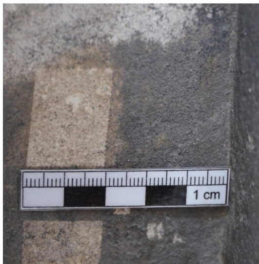
Obr. 30 Plocha k provedení zkoušky čištění pomocí uhličitanu amonného v gelu s Klucelem G
