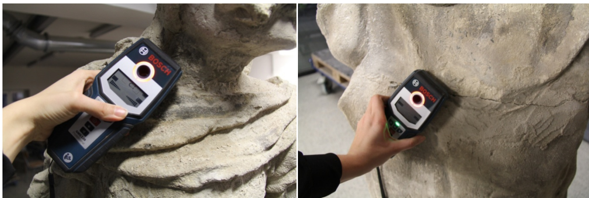
Obr. 6 Průzkum kovových prvků a armatur v kameni pomocí detektoru kovů
