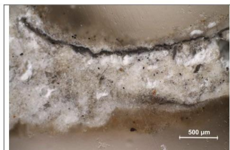
Mikrofoto v bílém odraženém světle, nábrus, fotografováno při zvětšení 100x
