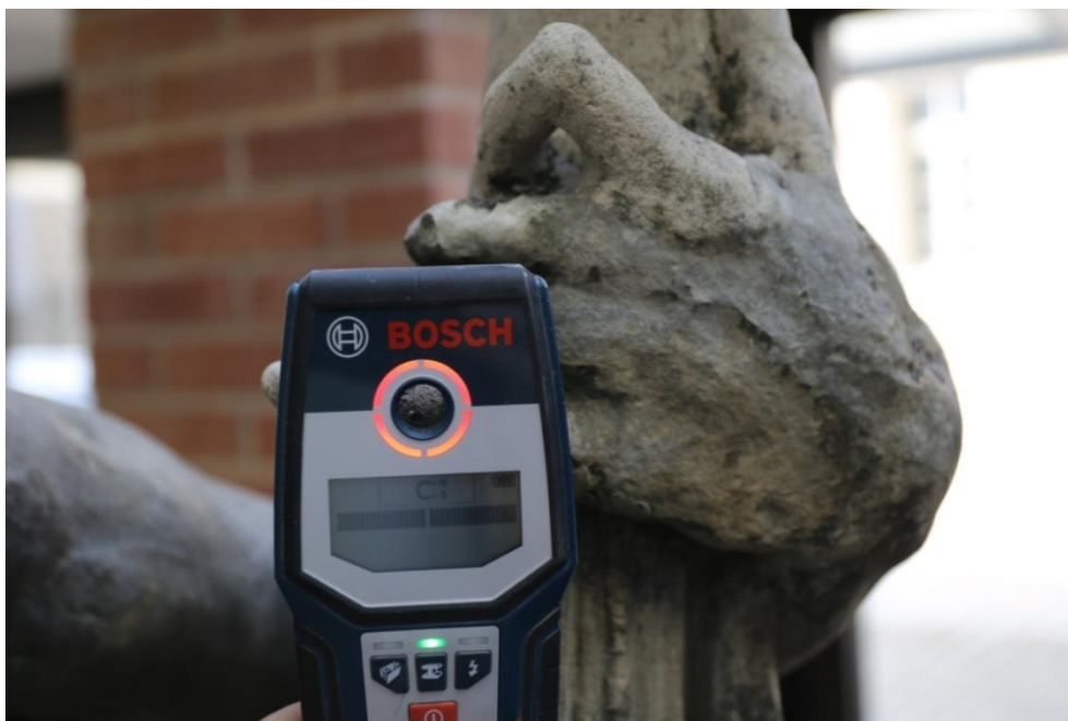
Obrázek 14: Přístroj GMS 120 Professional, na zjištění kovových vyztuží.
