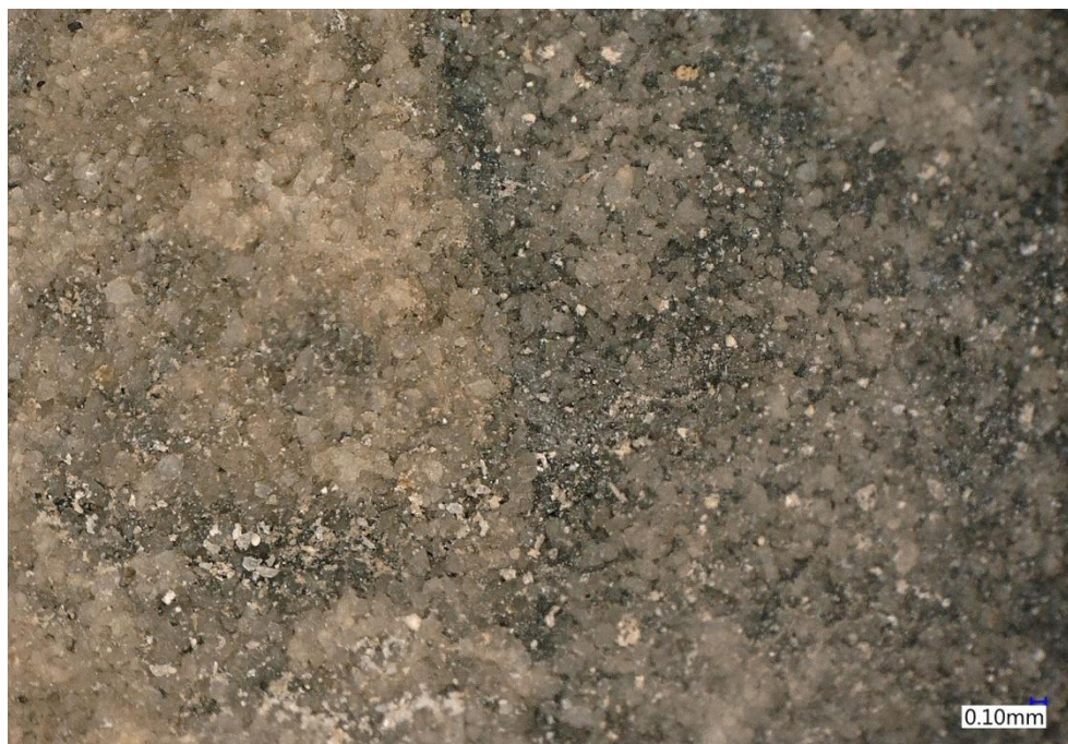
Obrázek 80: Ukázka čištění pomocí laseru pod mikroskopem větší zvětšení 25
