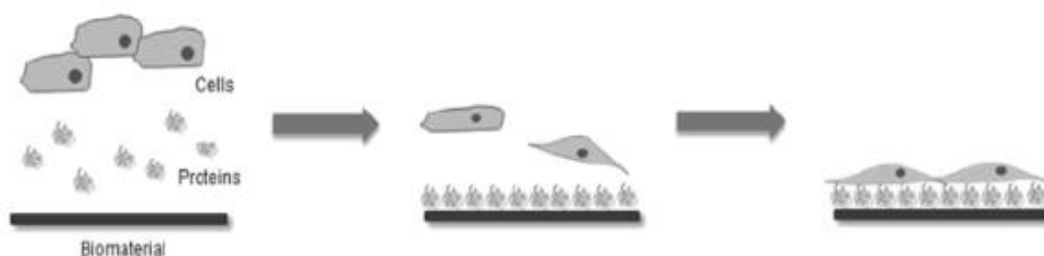
Obrázek 5: Adheze buněk na materiál – zjednodušené schéma po sobě jdoucích událostí, které se odehrávají na biomateriálu po implantaci. Samotná adsorpce proteinů na povrchu materiálu z okolního prostředí je poměrně složitý proces (Coutinho D. et al., 2011).
