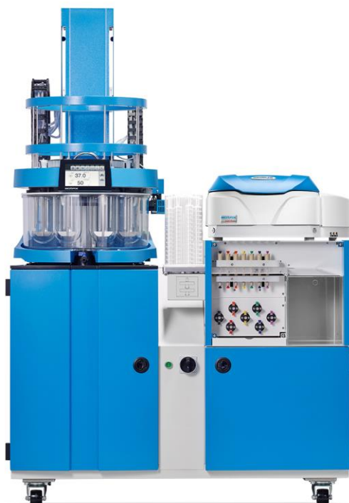
Obrázek 9 - Plně automatizovaný systém ATF Xtend s výsledky UV-Vis v reálném čase od firmy Sotax (převzato z [22])
