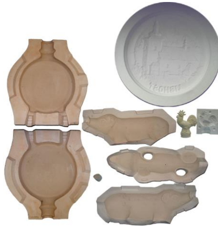
Obr. 6 Sádrové formy pro tvarování keramiky [14]
